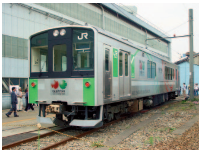
Рис. 5. Опытный вагон NE Train с гибридным тяговым приводом
