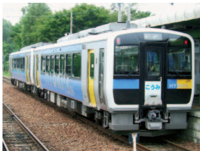
Рис. 6. Рельсовые автобусы Kiha E200 с гибридным тяговым приводом
