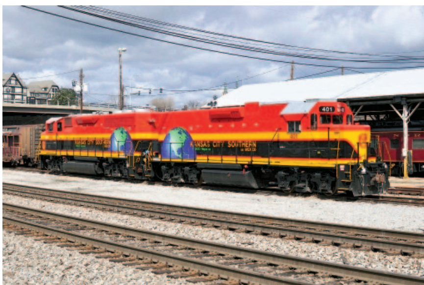
Рис. 3. Ремоторизированные тепловозы серии GP22 ECO-M железной дороги Kansas City Southern de México
