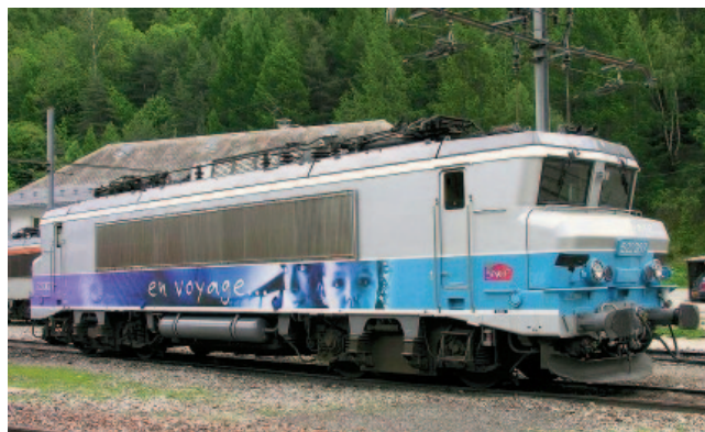
Рис. 4. Двухсистемный электровоз серии ВВ 22200 с мономоторными тележками, оснащенными редукторами с изменяемым передаточным числом
