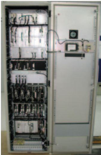
Внешний вид и структура бортового устройства ETCS со специализированными модулями передачи STM
