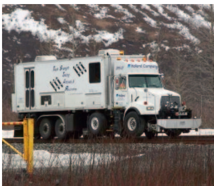
Рис. 1. Машина на комбинированном ходу TrackSTAR компании Holland
