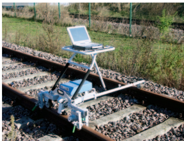
Рис. 4. Прибор WPG для испытаний вихретоковым методом, перемещаемый вручную
