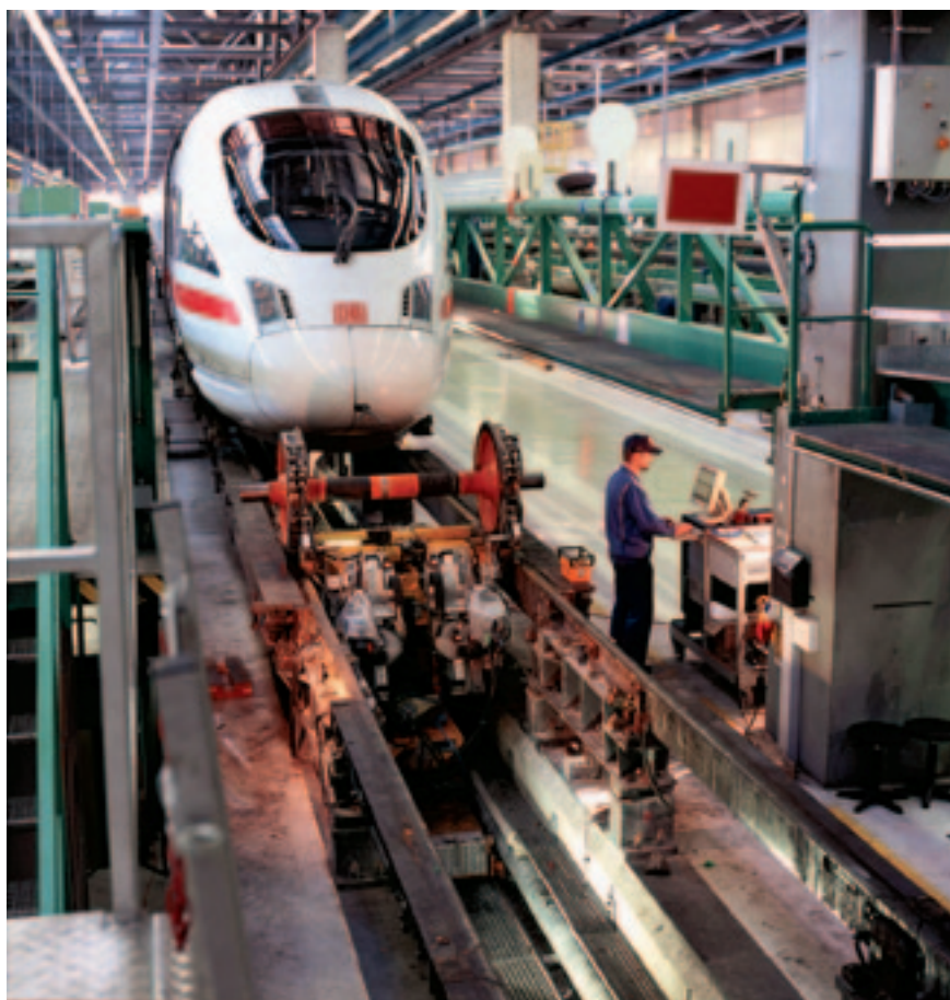
Рис. 2. Ультразвуковые испытания колесных пар в депо Мюнхен (фото: DB, Буссе)
