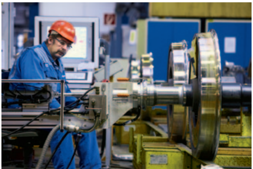
Рис. 4. Участок ультразвукового контроля колесных пар на заводе в Крефельде (фото: DB, С. Варгер)
