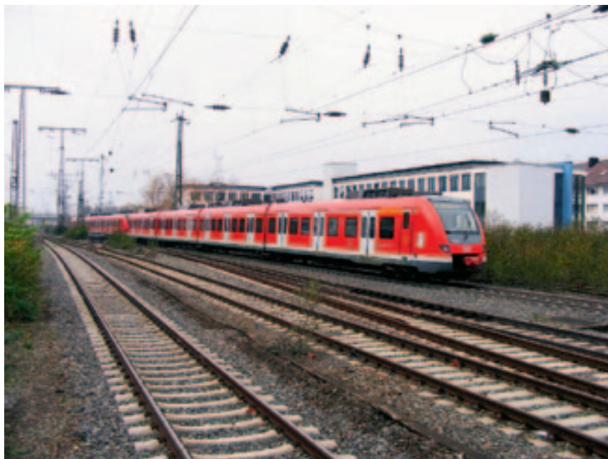
Рис. 4. Поезд, составленный из двух базовых секций серии 422
