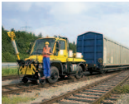
Рис. 4. Автомобиль на комбинированном ходу выполняет маневровые работы
