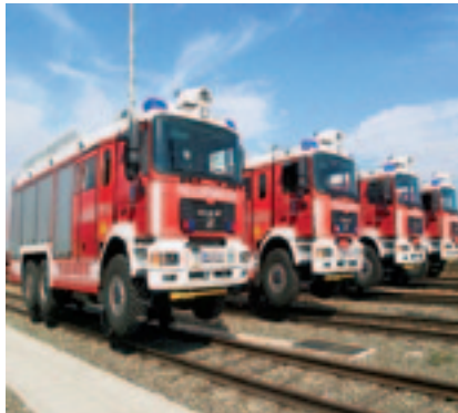
Рис. 2. Автомобиль категории 9А для тушения пожаров в тоннелях
