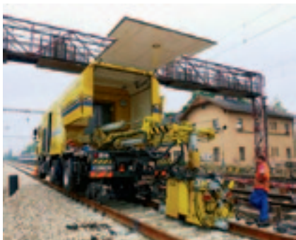
Рис. 1. Автомобиль на комбинированном ходу категории 9А с оборудованием для сварки рельсов
