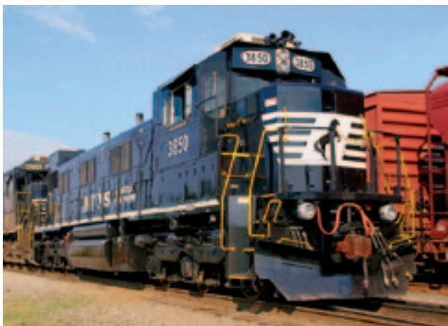
Рис. 6. Шестиосный тепловоз семейства N-ViroMotive постройки компании NREC на одной из станций железной дороги Norfolk Southern
