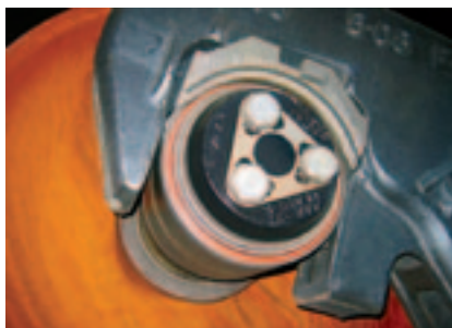
Рис. 8. Подшипниковый узел с лабиринтным уплотнением типа EcoTurn компании Timken (фото: Timken)
