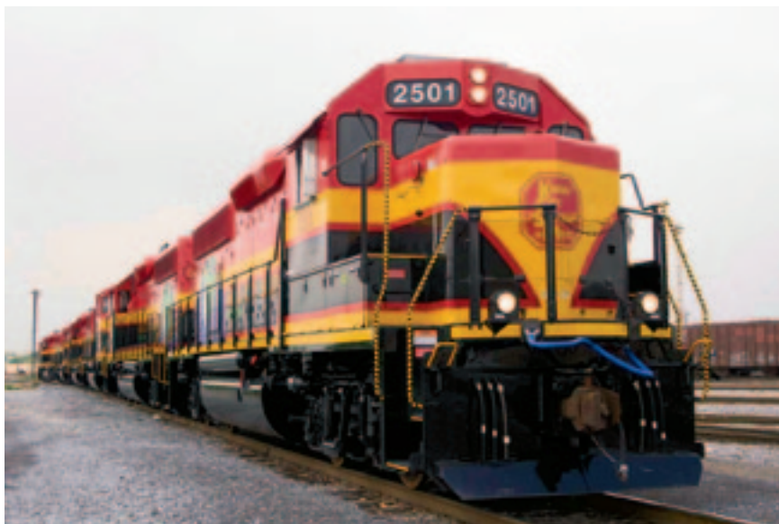
Рис. 2. Модернизированные тепловозы GP22ECO железной дороги Kansas City Southern, оснащенные силовыми установками 710ECO Repower компании EMD (фото: KCS)
