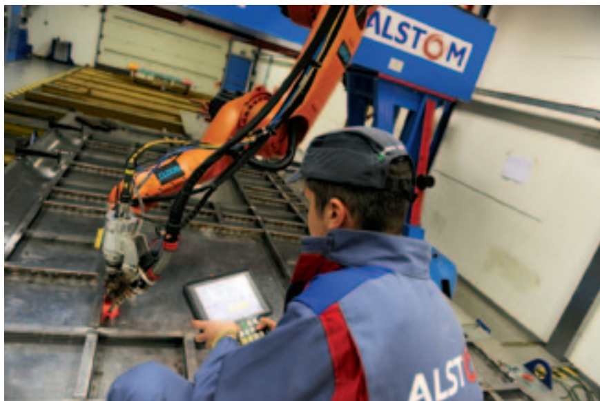
Рис. 2. Установка для роботизированной сварки деталей подвижного состава (фото: Alstom Transport/AIRDIASOL.ROTHAN)
