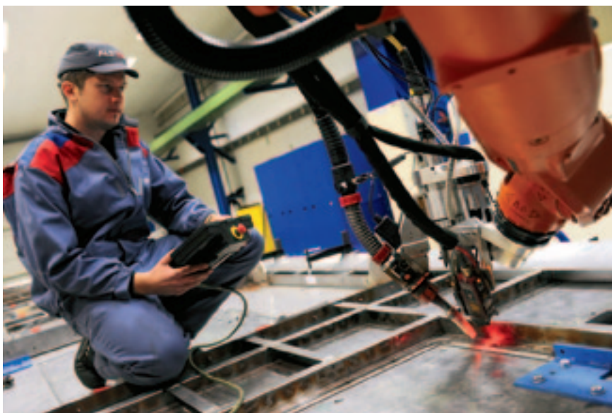
Рис. 1. Сварочный робот ALHIN (фото: Alstom Transport/AIRDIASOL.ROTHAN)
