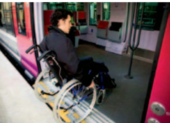
Рис. 6. Въезд пассажира на инвалидной коляске в вагон с использованием выдвижной рампы (фото: SNCF)
