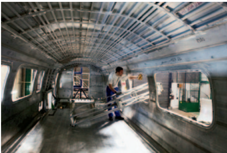
Рис. 1. Сборка прицепного промежуточного пассажирского вагона поезда TGV Duplex на заводе в Ла-Рошели (фото: Alstom)
