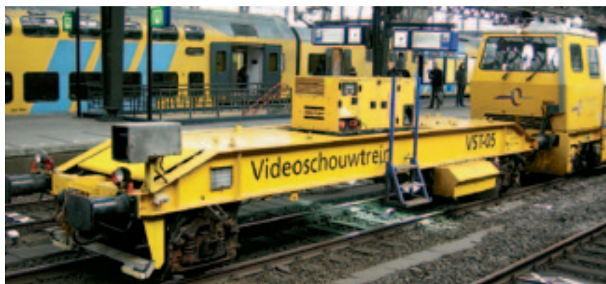
Рис. 1. Первая машина для видеоинспектирования пути
