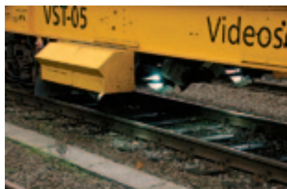
Рис. 3. Видеокамеры для регистрации состояния рельсов
