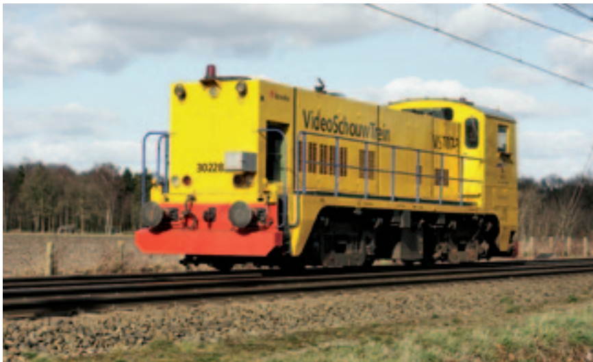
Рис. 2. Одна из новых машин для видеоинспектирования пути
