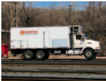
Рис. 2. Мобильная установка компании Chemetron для сварки рельсов в пути
