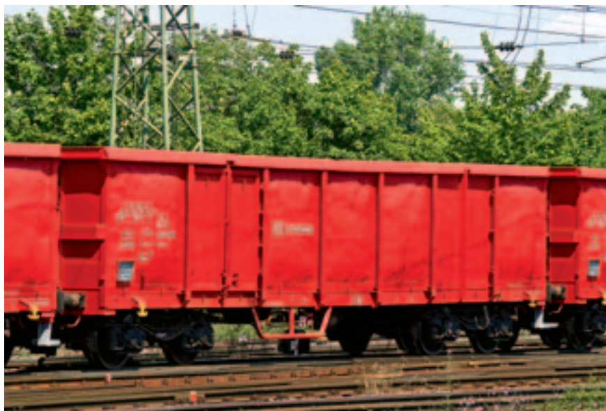
Рис. 4. Полувагон типа Eaos-x (фото: DB)
