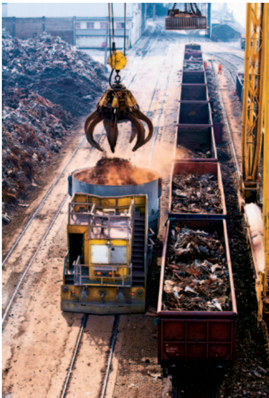
Рис. 4. Полувагон типа Eaos-x (фото: DB)
