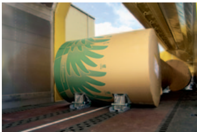
Рис. 1. Вагон типа Nabbiins 344 для сохранной перевозки рулонов бумаги (фото: DB)
