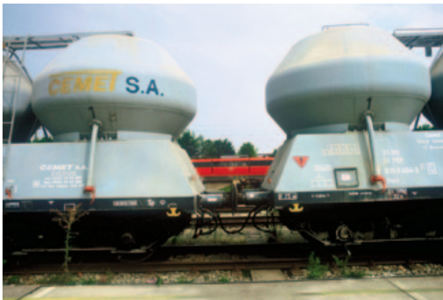
Рис. 6. Специализированный вагон для перевозки цемента (фото: DB)
