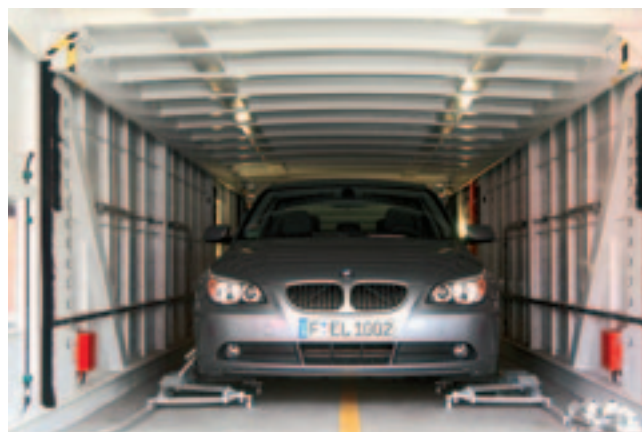
Рис. 2. Вагон типа Hscrrss для перевозки легковых автомобилей повышенного класса на выставке InnoTrans 2008 (фото: DB)
