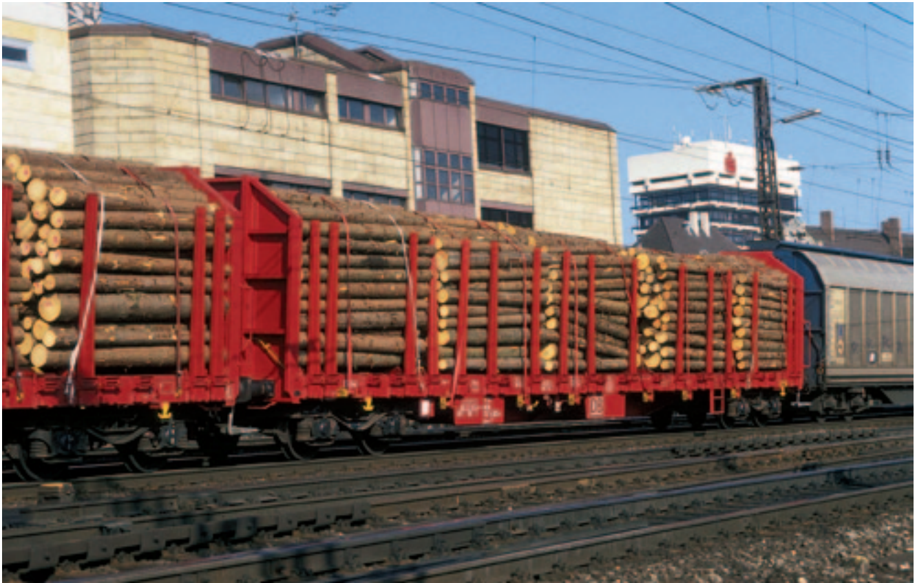
Рис. 3. Вагоны типа Roos для перевозки круглого леса (фото: DB)
