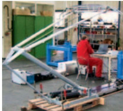
Рис. 2. Токоприемник на измерительном стенде компании DTK
