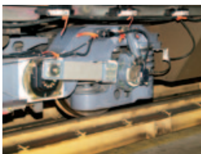
Рис. 7. Тележка электропоезда Regina, оборудованная системой ARS
