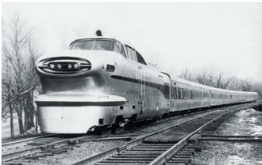
Рис. 2. Дизель-поезд Jet Rocket сообщения Чикаго — Пеория из вагонов Talgo II с моторным вагоном LWT12 компании EMD (фото 1956 г.)
