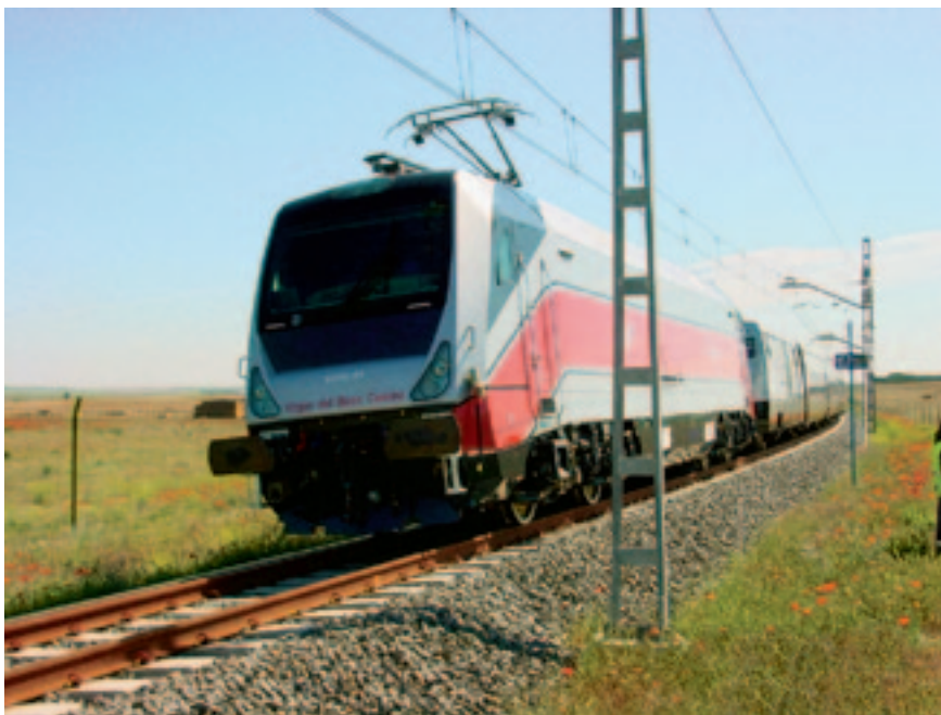
Рис. 5. Ходовые испытания электровоза Travca (фото: Talgo)
