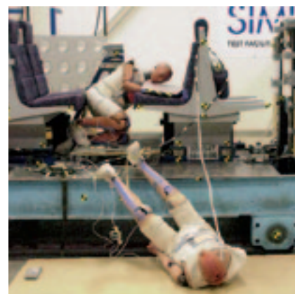
Рис. 11. Испытания компоновки и сидений пригородных поездов
