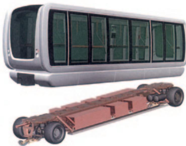
Рис. 3. Модули рамы и кузова вагона NeoVAL
