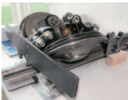
Рис. 5. Направляющая система с центральным рельсом
