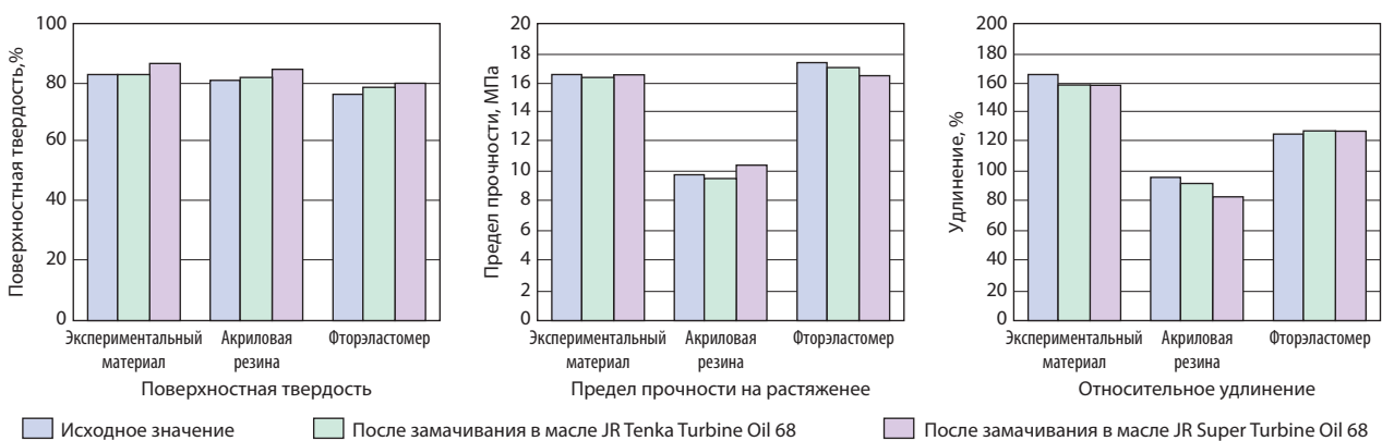
Рис. 3. Результаты испытаний резины обычных и экспериментального образцов на сопротивляемость воздействию смазочного материала
