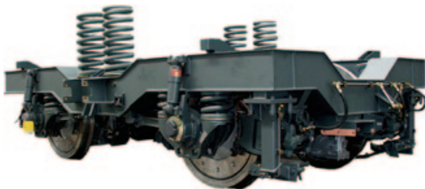
Рис. 2. Тележка головного моторного вагона поезда AVE S/102 (фото: Bombardier)
