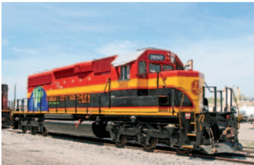
Рис. 3. Тепловоз серии SD22ECO железной дороги Kansas City Southern de Mexico мощностью 2150 л. с. (бывший тепловоз серии SD40, реторизованный EMD с установкой нового экономичного и экологичного дизеля типа V8 710G3A)
