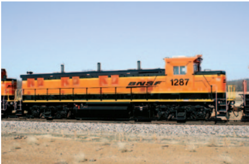
Рис. 1. Тепловоз серии 3GS21В железной дороги Burlington Northern Santa Fe, построенный NRE с использованием механической части старого четырехосного тепловоза и оснащенный тремя новыми дизелями компании Cummins мощностью по 700 л. с.
