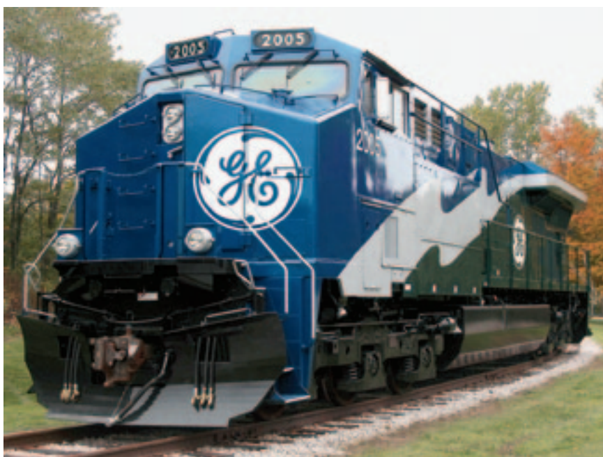
Рис. 4. Тепловоз семейства ES Evolution с дизелем типа GEVO (фото: GE Transportation Systems)
