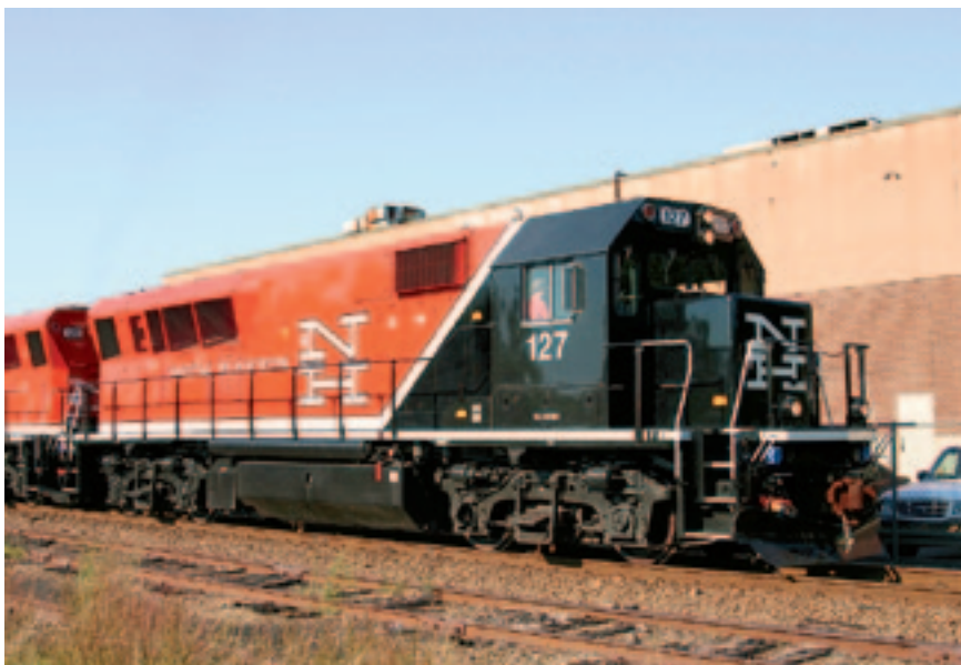
Рис. 2. Тепловоз серии BL20GH департамента транспорта штата Коннектикут постройки ВЕС, оснащенный дизелем компании MTU-Detroit Diesel и используемый в пассажирском движении
