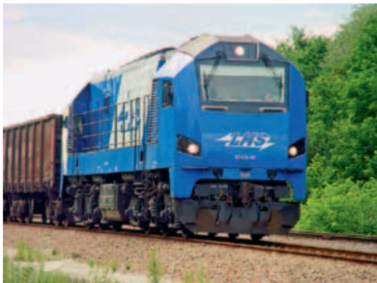
Рис. 7. Первый модернизированный тепловоз серии ST40s широкой колеи для компании-оператора PKP LHS
