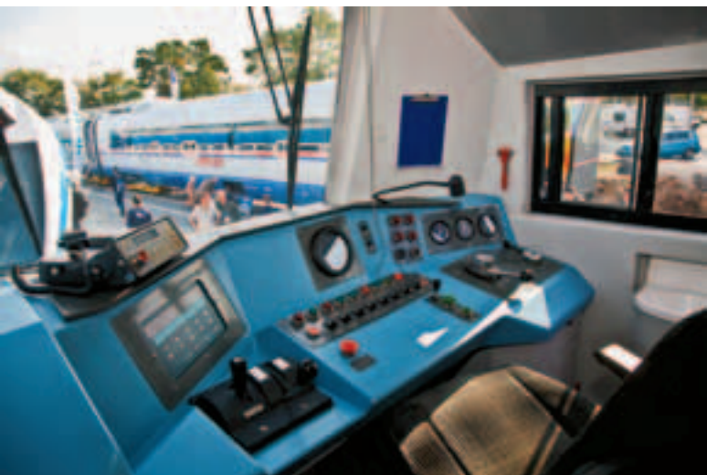
Рис. 5. Пульт управления модернизированного тепловоза серии M62
