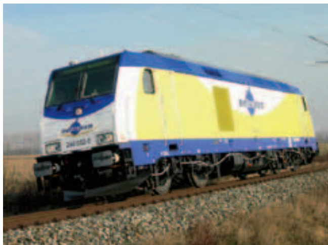
Рис. 1. Тепловозы TRAXX DE компании Bombardier Transportation: слева – в варианте P 160 (серии 246) для компании-оператора Metronom (фото: Bombardier); справа – в варианте F 140 (серии 285) для лизинговой компании CB Rail
