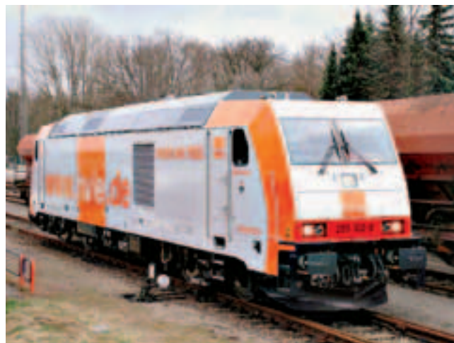
Рис. 1. Тепловозы TRAXX DE компании Bombardier Transportation: слева – в варианте P 160 (серии 246) для компании-оператора Metronom (фото: Bombardier); справа – в варианте F 140 (серии 285) для лизинговой компании CB Rail
