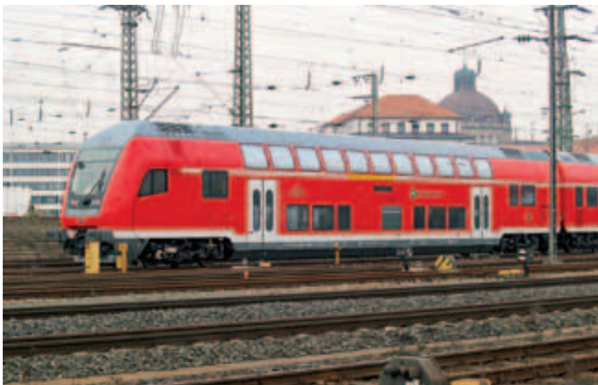
Рис. 7. Вагон DBpzbfa 766.2 с кабиной управления (модификация с опытными тележками для скорости движения 230 км/ч) (фото: DB, Вебер)
