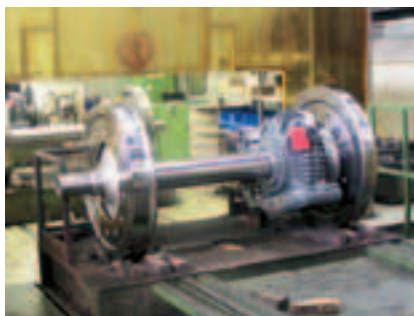
Рис. 4. Колесная пара компании BVV с тяговым редуктором
