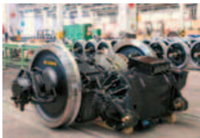
Рис. 3. Колесно-моторный блок с колесной парой компании Lucchini Sidermeccanica
