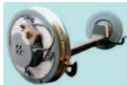
Рис. 2. Колесная пара компании GHH для вагона трамвая с низким уровнем пола
