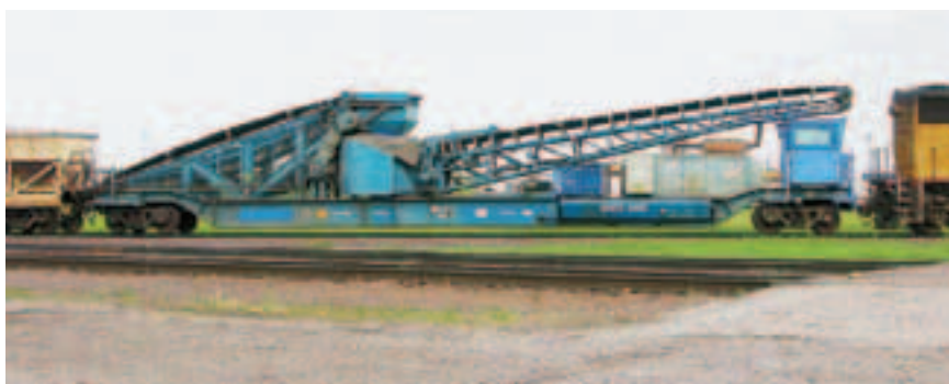
Рис. 3. Вагон балластного поезда компании Georgetown Rail Equipment с поворотной стрелой
