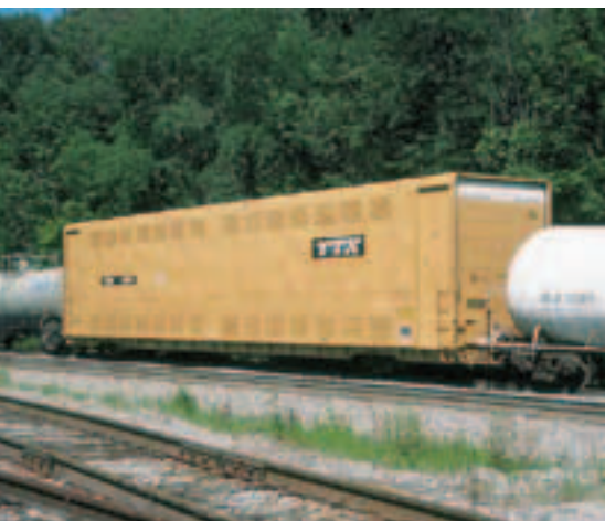
Рис. 2. Вагон компании ТТХ для перевозки автомобилей
