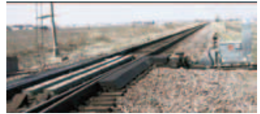
Рис. 2. Установка для обогрева стрелочных переводов типа Hellfire 400 корпорации HI
