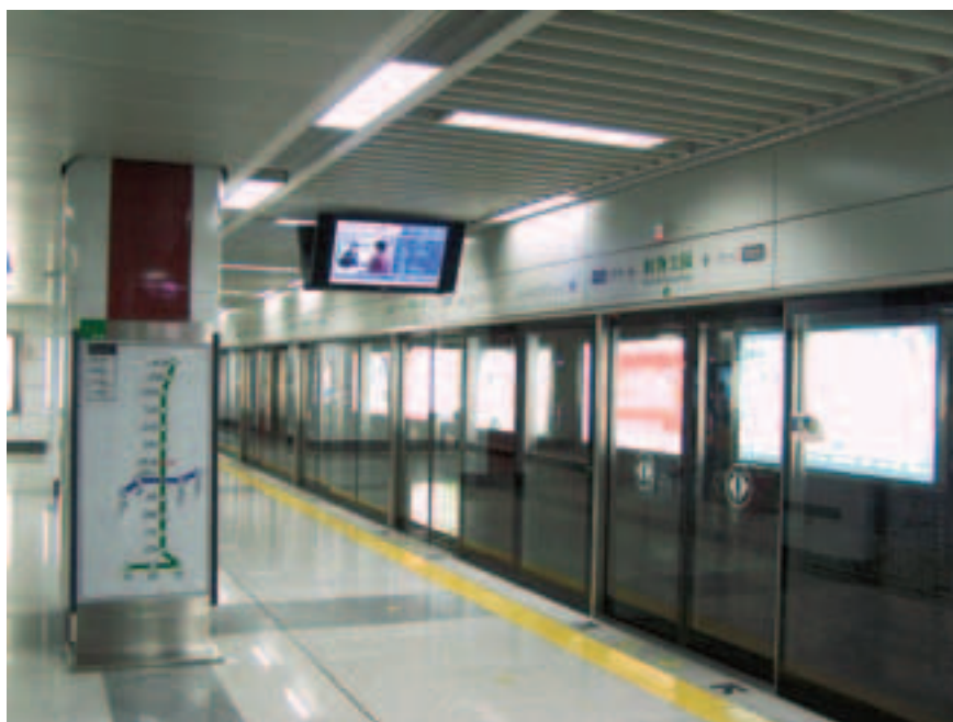
Рис. 1. Платформа с раздвижными дверями на одной из станций метрополитена в Шэньчжэне (Китай)
