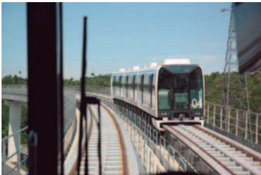
Рис. 7. Линия транспортной системы на магнитном подвесе Linimo в Нагое (Япония)
