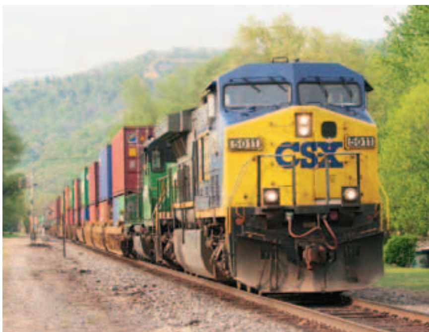
Рис. 4. Поезд смешанных перевозок железной дороги CSX с контейнерами, погруженными в два яруса
