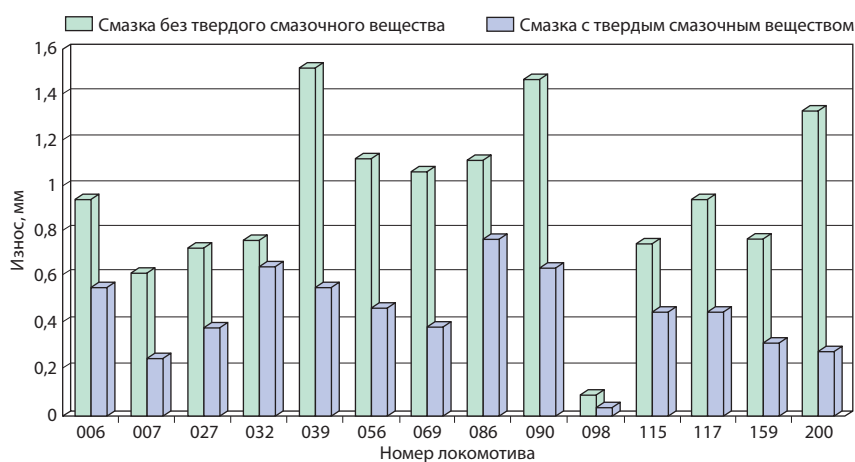
Рис. 3. Суммарный износ восьми гребней бандажей у локомотивов серии 219 после пробега 1000 км
