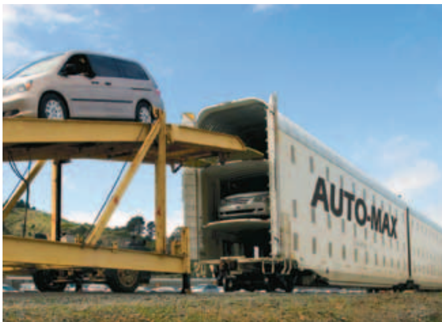
Рис. 4. Сочлененный вагон компании Greenbrier для перевозки автомобилей в три яруса
