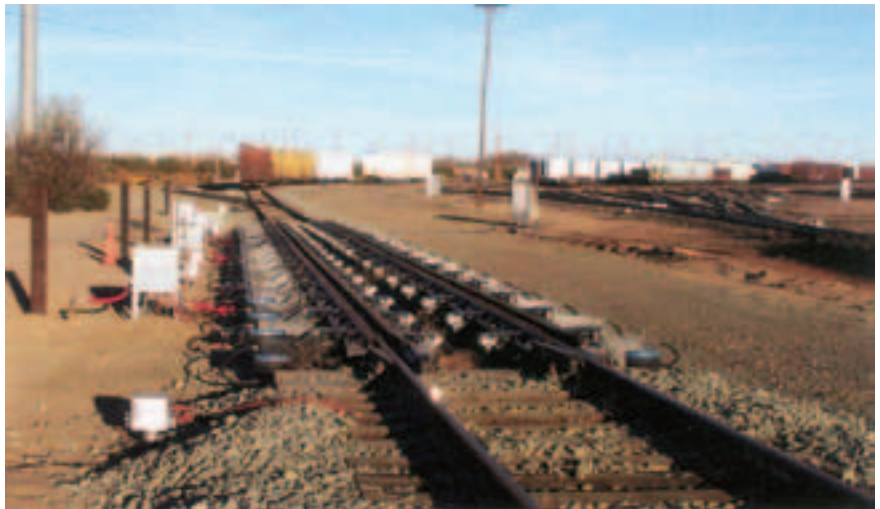
Рис. 3. Подгорочная тормозная позиция с вагонозамедлителем типа SR 2000
