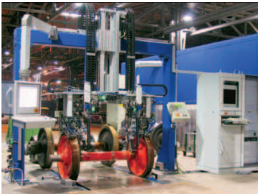
Автоматизированная установка для обмера колесных пар на заводе компании SRS
