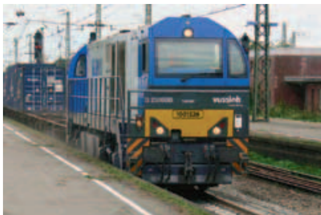
Рис. 1. Базовый вариант тепловоза G 2000 BB с асимметричной кабиной
