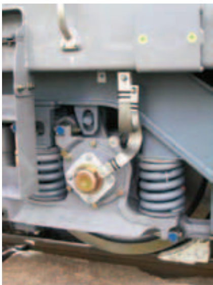
Рис. 5. Тележка типа У 412 (вверху — общий вид; внизу — буксовый узел и первая ступень рессорного подвешивания)
