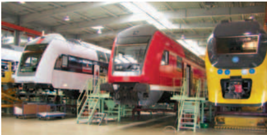
Сборка двухэтажных вагонов за заводе в Гёрлице (фото: Bombardier)
