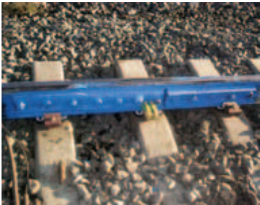
Рис. 3. Изолирующий стык с косым срезом торцов рельсов
