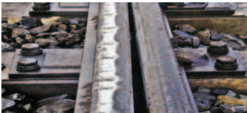
Рис. 10. Рельс с волнообразным износом
