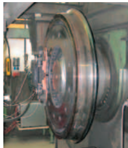
Рис. 4. Испытательный стенд и установленный на нем тормозной диск с накладкой типа ISOBAR
