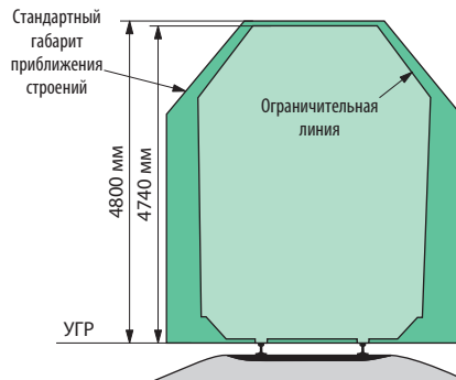
Рис. 1. Ограничительная линия и стандартный габарит приближения строений
