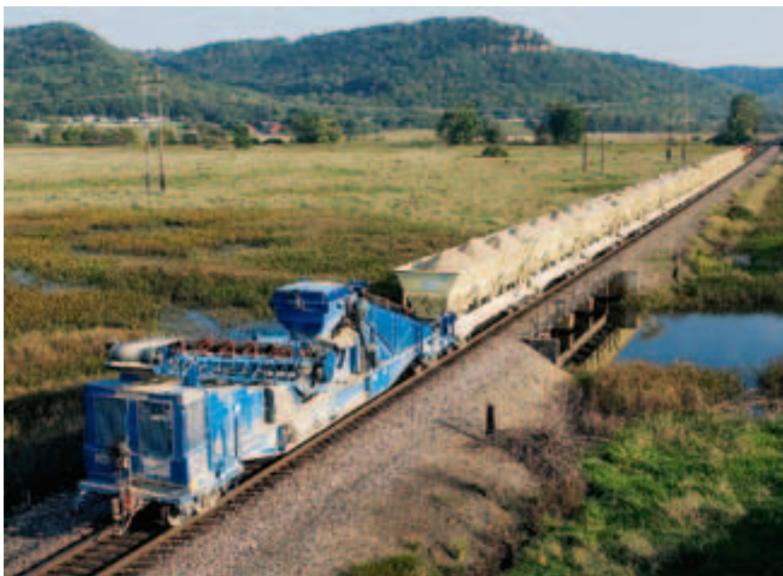
Рис. 2. Балластоукладочный поезд компании Georgetown Rail Equipment
