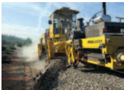
Рис. 6. Распределитель балласта PBR-2005 корпорации Plasser American в работе
