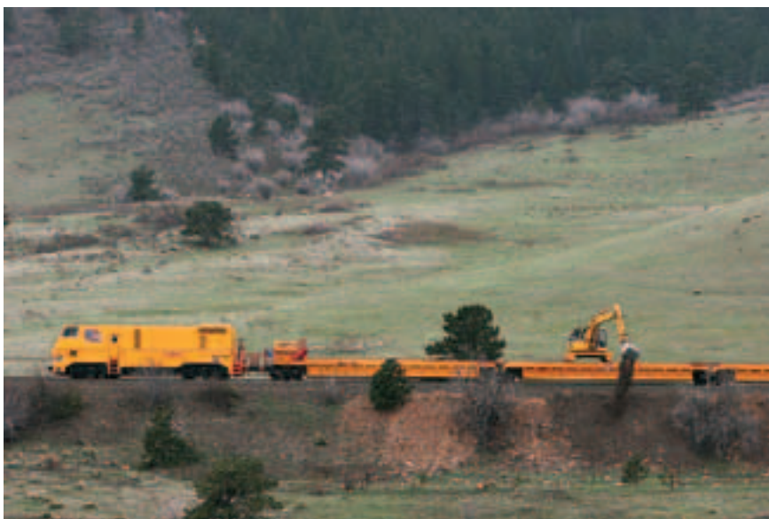
Рис. 3. Самоходная многофункциональная машина МРМ компании Herzog
