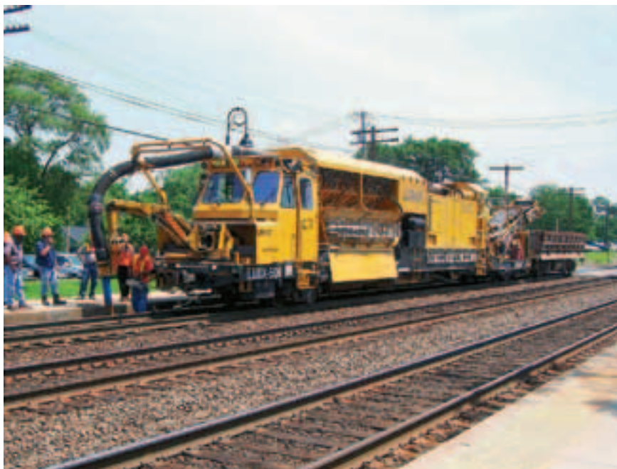
Рис. 5. Балластоочистительная машина Railvac корпорации Loram Maintenance of Way
