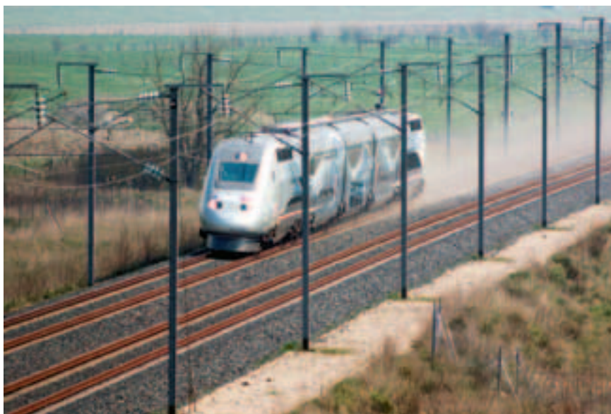
Рис. 6. Электропоезд TGV во время установки нового мирового рекорда скорости на железных дорогах (574,8 км/ч). В ходе этой поездки использовалась система радиосвязи GSM-R, а взаимодействие с напольными приемопередатчиками ETCS было протестировано на скорости до 512 км/ч
