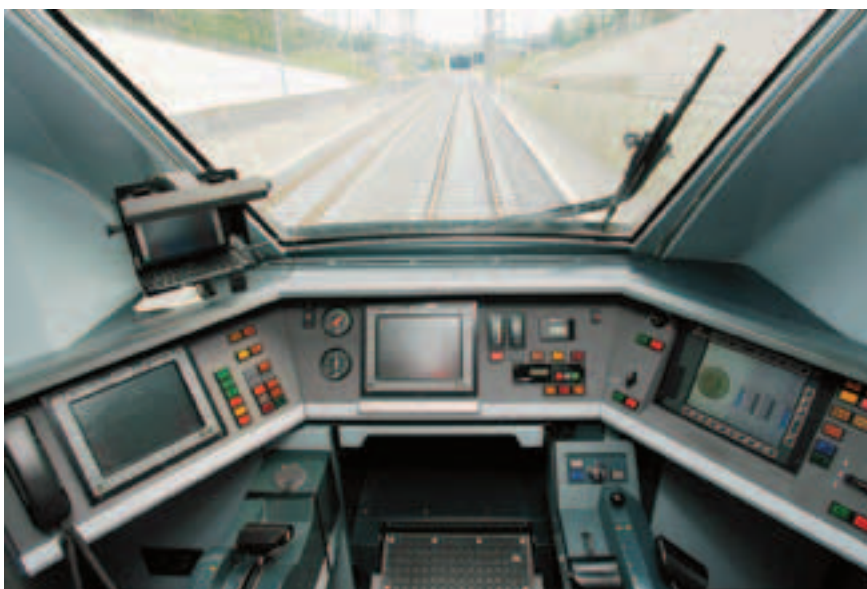
Рис. 1. Кабина машиниста электропоезда ICN Федеральных железных дорог Швейцарии, оборудованного системой ETCS уровня 2
