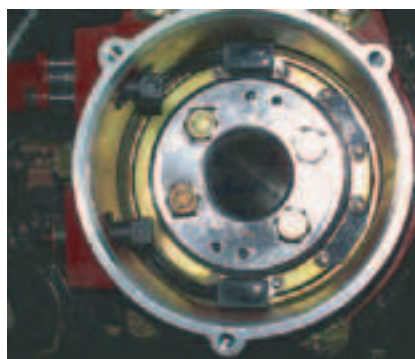
Рис. 5. Установка датчиков на итальянском высокоскоростном поезде серии ETR 500
