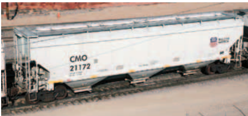
Рис. 2. Крытый хоппер группы TrinityRail для перевозки зерна
