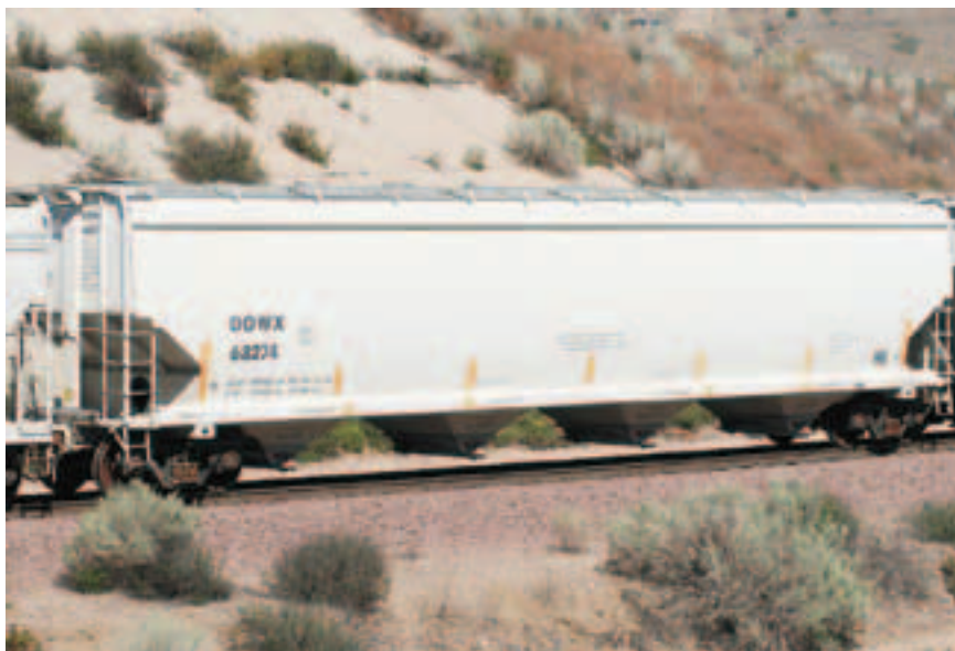
Рис. 4. Крытый хоппер компании National Steel Car для перевозки гранулированных грузов
