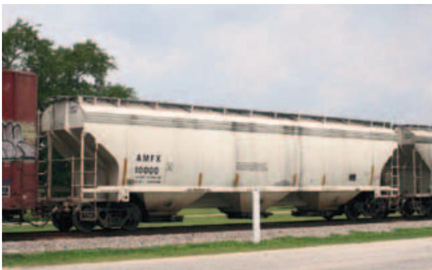
Рис. 3. Крытый хоппер типа CF5650ON компании American RailCar Industries для перевозки муки и крахмала
