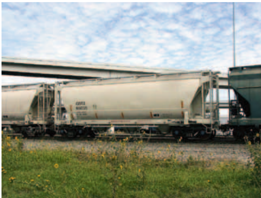
Рис. 1. Крытый хоппер компании Greenbrier для перевозки зерна
