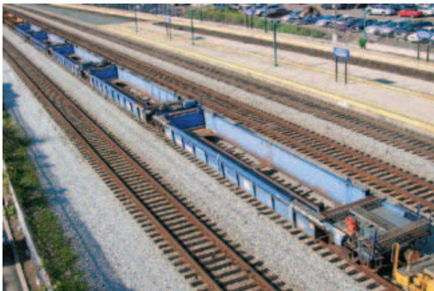
Рис. 5. Пятисекционная платформа для перевозки контейнеров в два яруса
