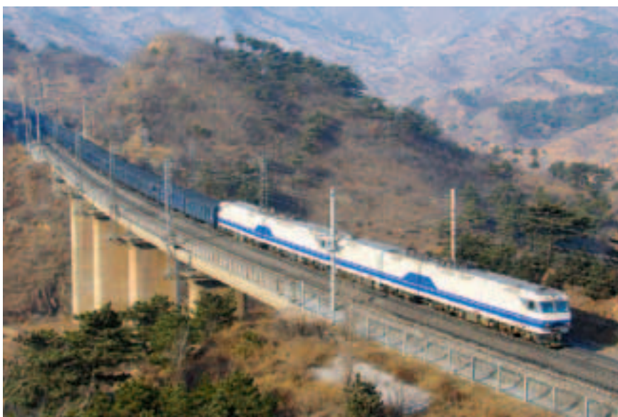
Рис. 3. Тяжеловесный углевозный поезд массой 12 тыс. т железных дорог Китая вблизи города Чанпин
