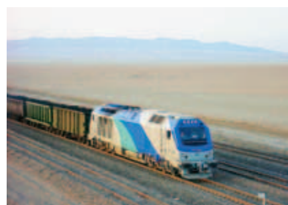
Рис. 4. Грузовой поезд железных дорог Ирана, ведомый тепловозом семейства Prima постройки компании Alstom
